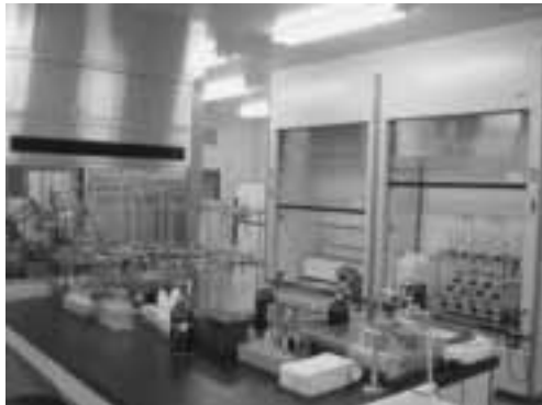
写真2. 複数のドラフトが設置された前処理室
