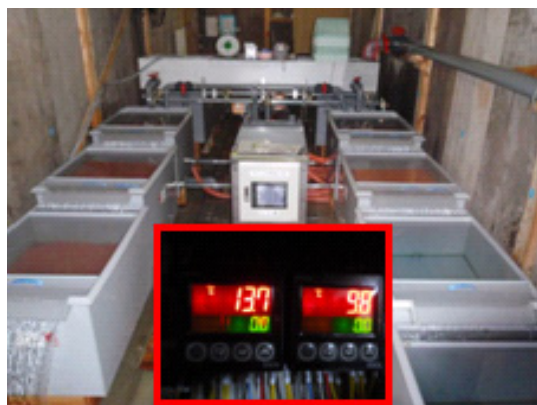
図2 耳石温度標識装置（2機設置）及び温度表示版（源水温 11.8℃に対し、 \pm 2^\circ\text{C} で加温（右）と冷却（左））
