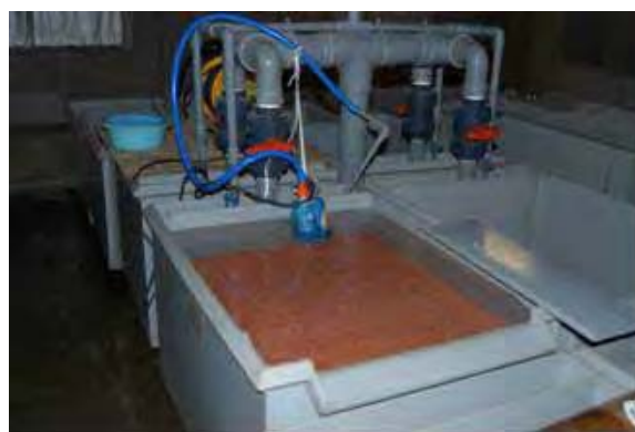
図 1．ボックス型ふ化槽による循環式薬浴の効果試験．小型のポンプを用いて 30 l/分の流量で循環した．
