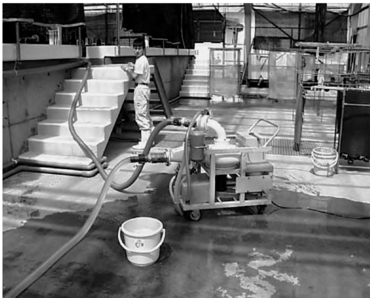
写真Ⅲ-12 種苗生産したヒラメを後期育成水槽に輸送する種苗輸送ポンプ
