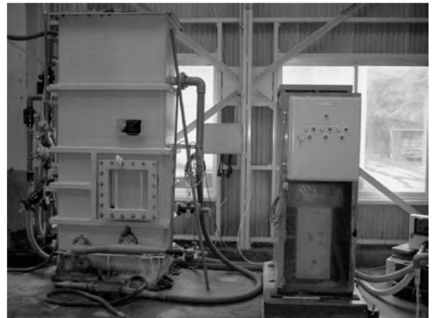
写真Ⅲ-6 オキシダント海水を調製するオゾンバリア
