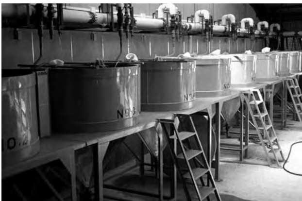
写真II-1-1. アクリル製円錐形のふ化水槽（五島栽培センター）
