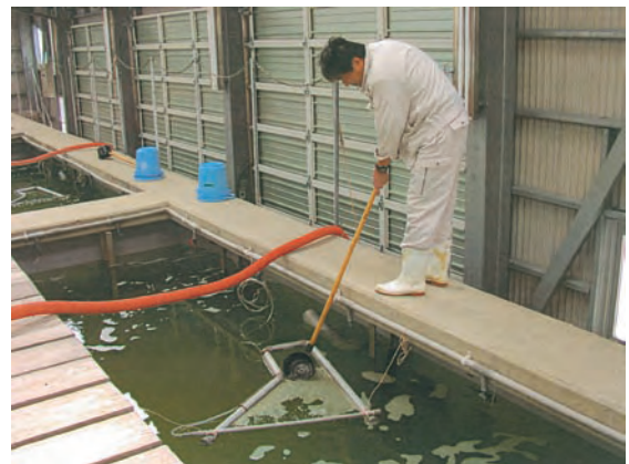
写真II-2-19. 柄杓による油膜除去
