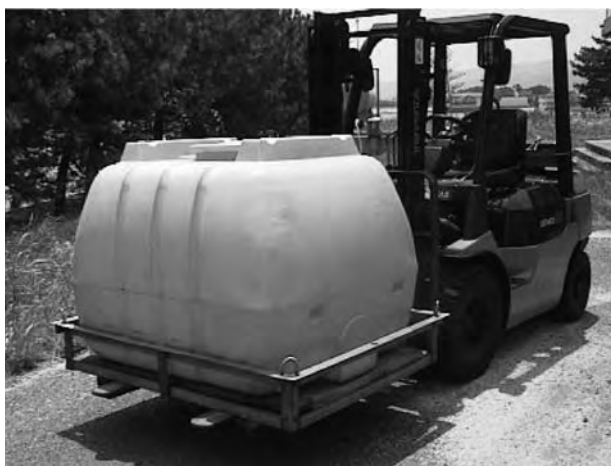
写真Ⅲ-2-2 輸送水槽と専用枠（屋島栽培センター）
