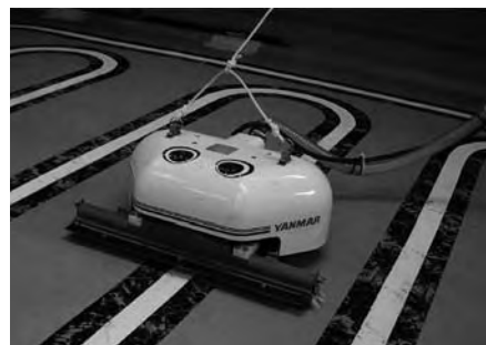
写真Ⅱ-2-13. 自動底掃除機（ライン読み取り走行型）
