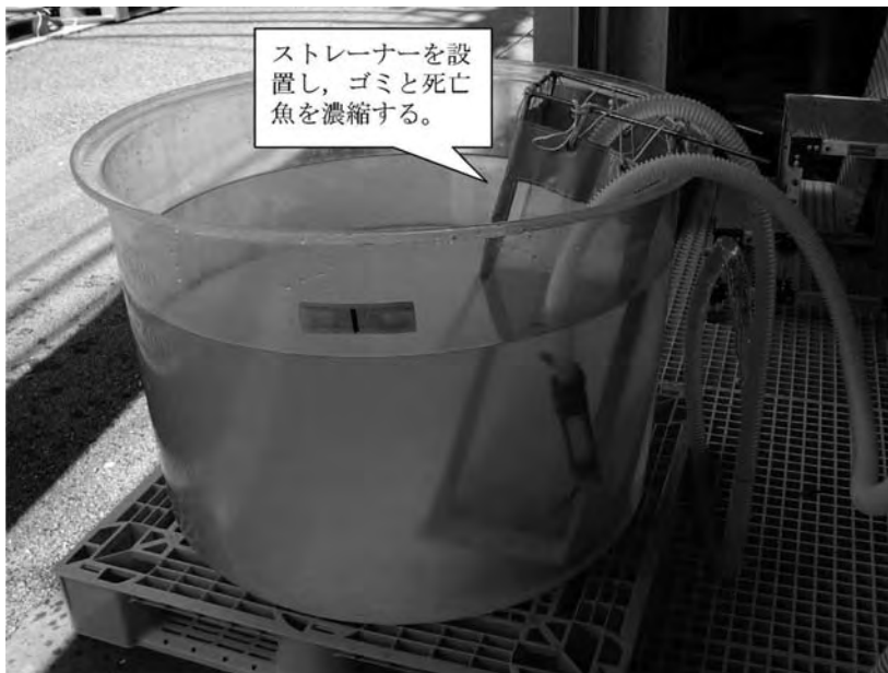
写真Ⅱ-2-16. 底掃除による排水を回収する排水受水槽
