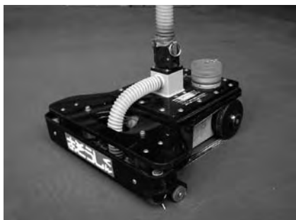
写真Ⅱ-2-12. 自動底掃除機（バッテリー駆動、ランダム走行型）
