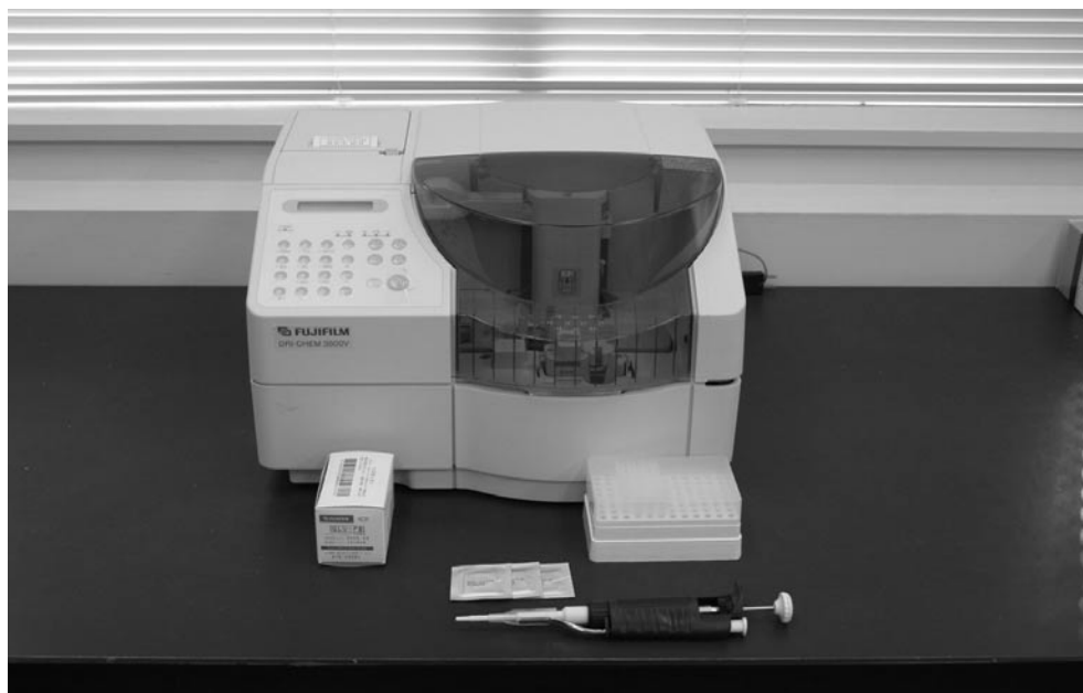
写真3-4. 親魚血液の生化学的性状検査に使用する血液分析装置 (ドライケム; 富士フィルム製)
