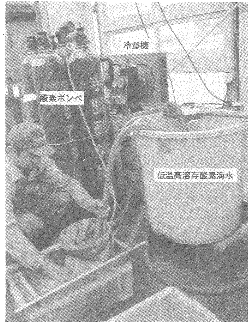
図Ⅲ2-2 低温高溶存酸素海水への入れ換え作業
