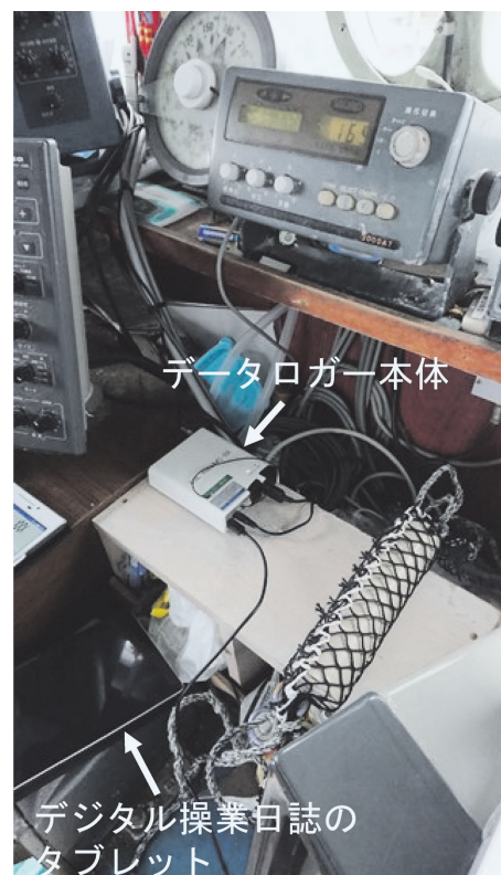
図1. 新潟県上越地区の小型底びき網漁船に搭載したリアルタイム機器
