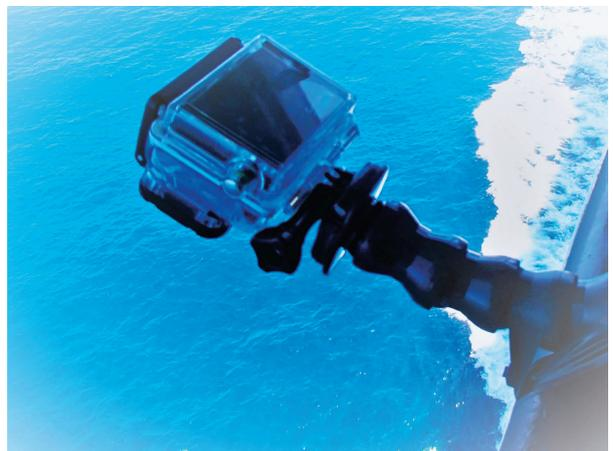
図3. 船に設置した小型ビデオカメラ
