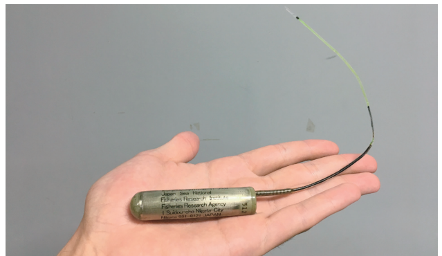
図1. ブリに装着して回収されたアーカイバルタグ。ケーブルの先端は水温と照度のセンサーになっており、本体に温度と圧力のセンサーがついている。最近では、数グラム程度にまで小型化が進んでいるものもある。
