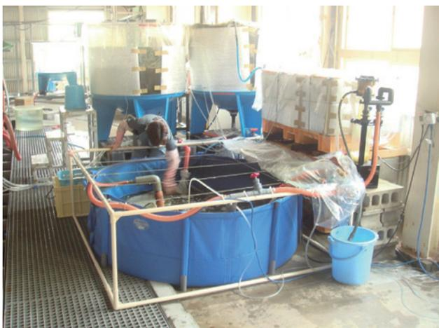
図3 閉鎖循環式培養装置の全体写真（受水槽でワムシを収穫中）
