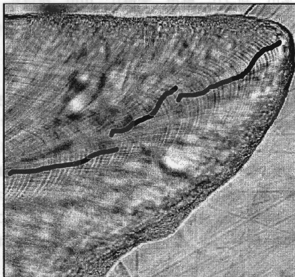
本系計測軸の計測形 中間部のテクスチャによる誤差が大きい。また、直線計測軸の影響で、計測結果が誤差となる。
