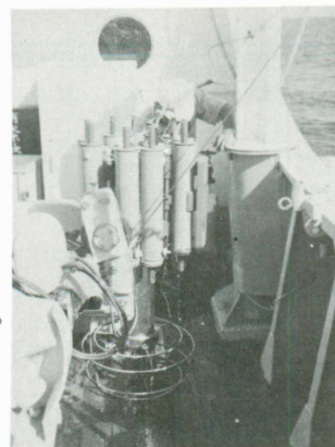
STD (9040-1A)のフィッシャーおよびロゼットサンプラー(RMS-12BBSTD)
