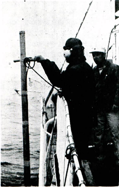
図 4. 調査船北光丸の舷側に設置された受波器の支柱
