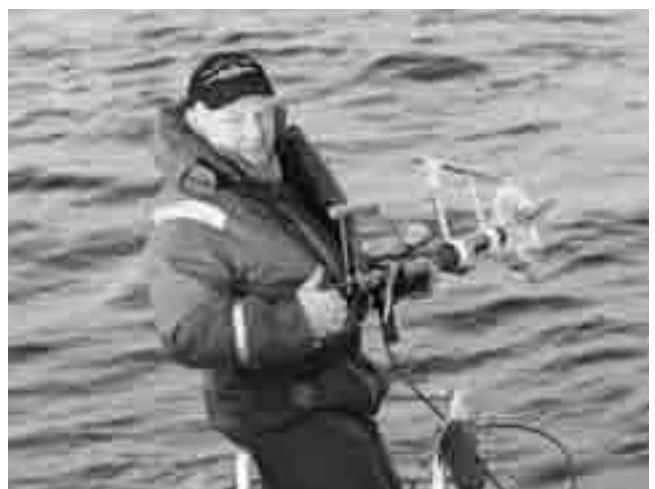
図13 ブラストール号船首プラットフォームでLK-ARTSを構えるクレイバン氏 このLK-ARTSにはオプションの圧力計と照準、肩当てが装着されている。ホースは船首に固定した小型エアポンペに接続されている(この写真だけモノクロ)。
