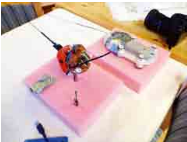
図14 DTAGハウジング（奥）とCTAG（手前） 手前のスポンジに刺さっているのはCTAG用アンカー。
