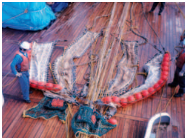
図1. 新網NBT-2P-SYのカイトとロープ網前端口
