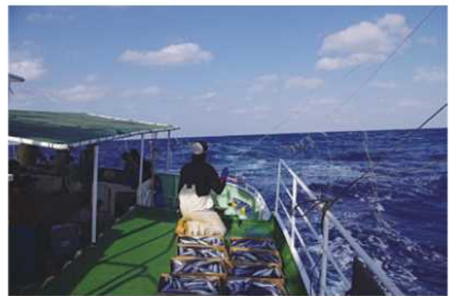
図1. オドシ付きトリライン。黄色のヒラヒラ（PPバンド）がオドシと呼ばれる海鳥を船尾付近でトリラインの下を飛行しないようにする機構。写真は第二大慶丸調査より
