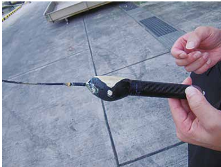
図3. 鉋子で回収された Microwave Telemetry 社の PAT。PAT の一部が割れて灰色の浮力体断面が露出している。
