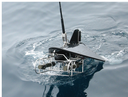
写真1. 曳航用Vフィンと共に使用中のVPR 前方2つの円筒形耐圧容器がカメラとストロボ
