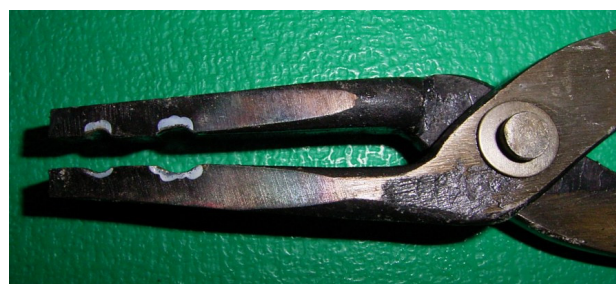
図1. 新開発した海亀用釣鉤外し器(全長 300mm, 先端部の溝で釣鉤をつかんで外す)。見栄えが悪いとの声もあったが…
