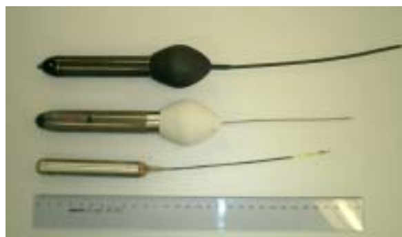
図1. ポップアップタグとアーカイバルタグ 上から、MT社、WC社のポップアップタグで、下がLOTEK社のアーカイバルタグ。
