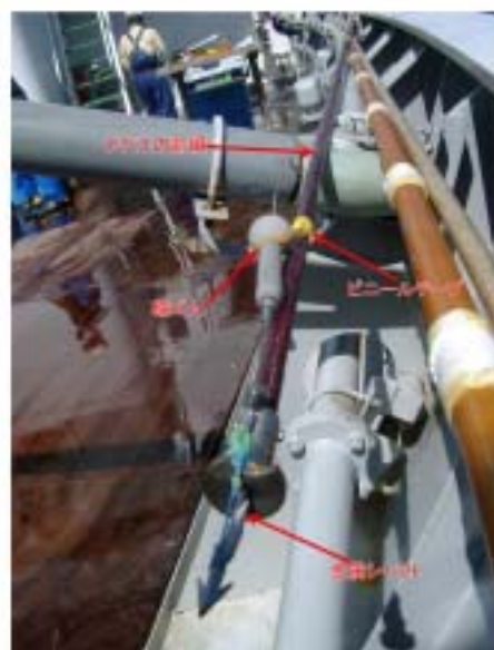
図8. 今回使用した Pop-up satellite tag の仕立て (上図)、下図は長さ 5m のガラスファイバー製のモリへの装着状態 (Wilson 博士撮影)
