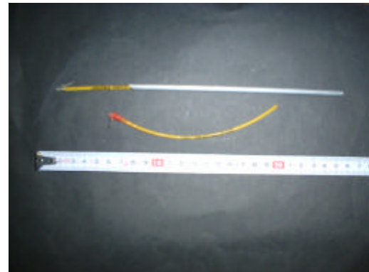
図1. 初めに使ったダートタグとパイプ カエシの接合部は、糸やステンレスワイアで補強したが、パイプの断面によって切断された。パイプも肉薄でつぶれ易かった。
