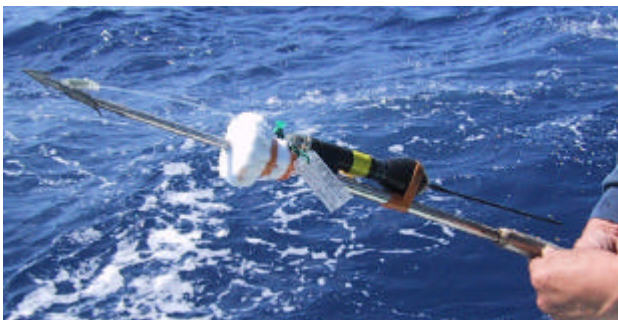
図 6. 突きん棒方式のポップアップタグ装着システム
