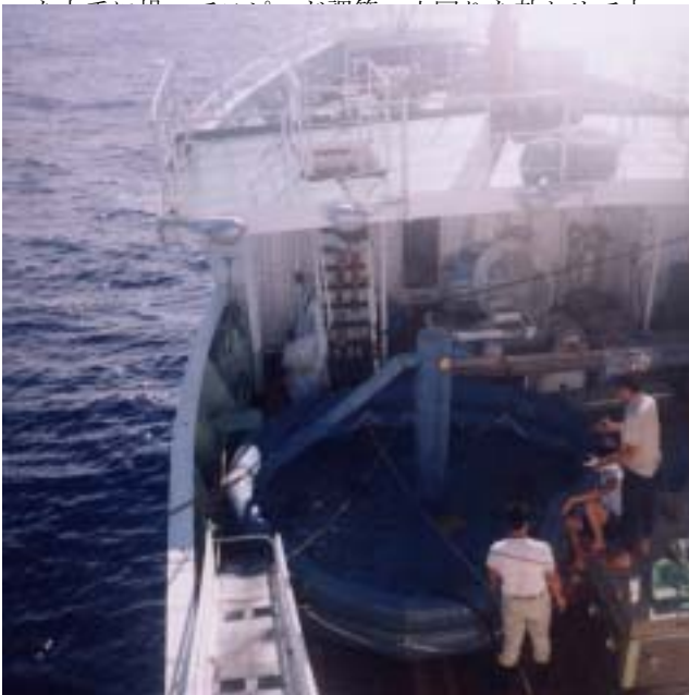
図4. 甲板上に設置した中古救命筏利用の水槽(直径約4m)
