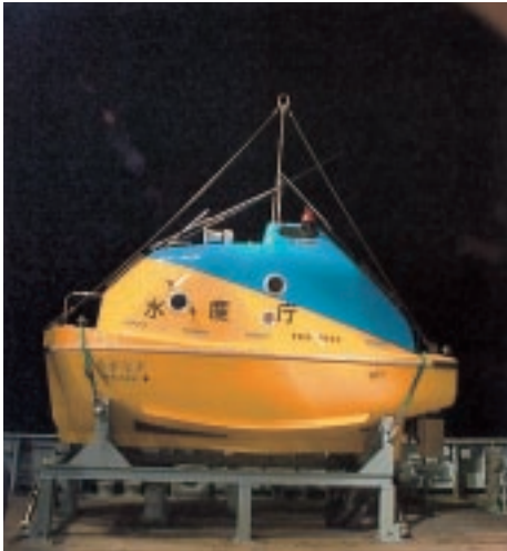
図2 照洋丸に搭載された無人水中観測艇「みずなぎ」。船底中央に測器格納用のドームがあり、CTD、水中カメラのユニットが収められている。
