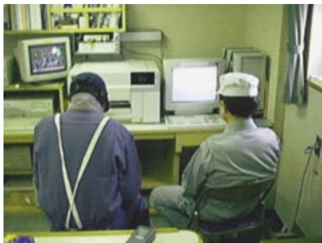
船上局 ▶ 水中のネットの状態をリアルタイムで監視しながらネットの開閉及びデータ収集をおこなう。
