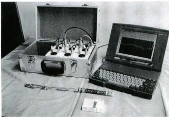
写真1 小型水深水温計システム(6ポッドタイプ)手前がプローブ(水中部)で、延縄に取り付けるためのスナップが付いている。後方左のトランクは電源部とポッド(6ヶ見える黒く丸い穴)が一体になっている。プローブをポッドに差込んで充電やパソコンとのデータ通信を行なう。後方右がデータ処理用のパソコン。GPSレシーバはこのパソコンとつながっている(写真には示されず)。
