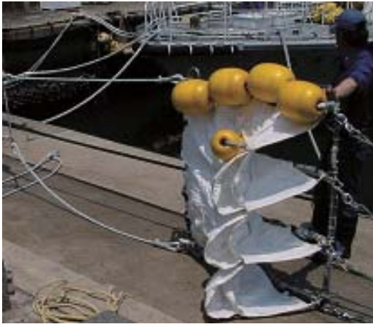
Fig. 5 小型漁船用に試作したキャンバス製カイト
