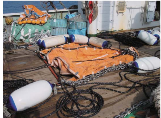
Fig. 2 サイドトローリング曳網試験に用いたキャンバス製カイト
