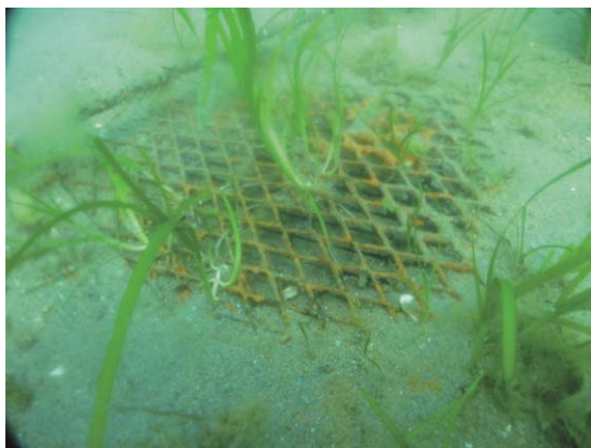
Photo. 16 逗子ヶ浜海域開放域大型型枠 セメント系3% (2004/4/20) 型枠底部のエキスパンドメタルに地下 茎を絡ませて草体を固定するアマモ
