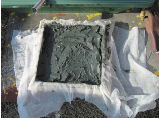
Photo. 4 脱型設置型木製小型型枠アマモ種子播種
