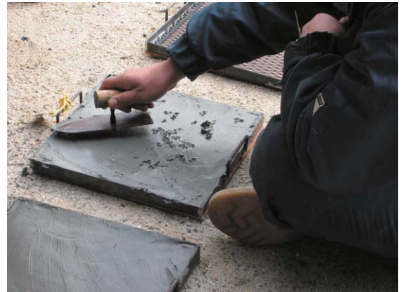
Photo. 2 一体設置型鋼製型枠固化体アマモ種子播種
