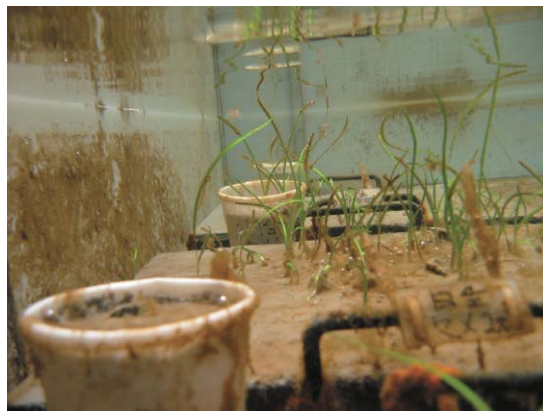
Photo. 9 岡山水産試験場屋内水槽黒島泥底質セメント系2% (2003/4/17) 出芽・初期生長状況
