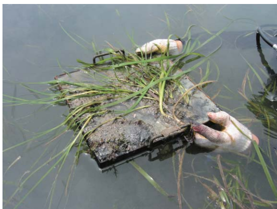
Photo. 14 岡山県水産試験場地先セメント系2% マグネシウム系1%混合(2004/6/10) 海域移設後の生長状況
