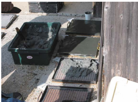
Photo. 1 一体設置型鋼製型枠固化体打設・成型
