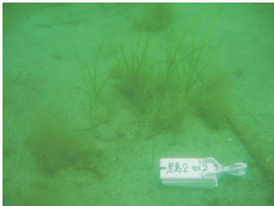
Photo. 12 逗子ヶ浜海域黒島泥底質 セメント系2%(2003/5/20) 出芽・初期生長状況
