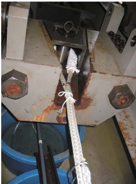
Photo. 5 試験体の取り付け状況 ( 20の場合)
