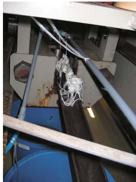
Photo. 6 試験体の破断状況 (20の場合)
