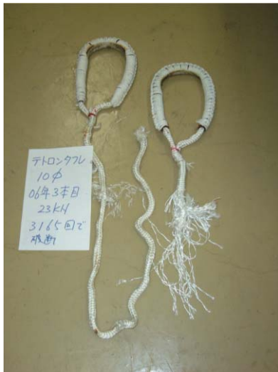
Photo. 9 実験ケースの破断状況
