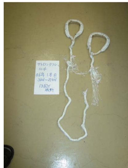
Photo. 7 実験ケース1の破断状況
