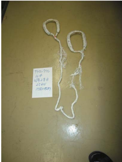
Photo. 8 実験ケース2の破断状況
