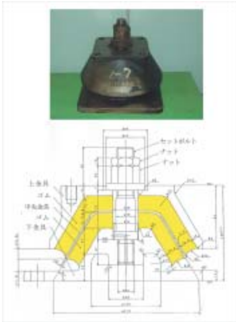
Fig. 3 防振ゴム構造図防振ゴム構造図
