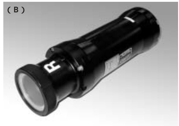
図6 水中TVカメラに装着した交換用レンズ (A)標準レンズ (B)2倍テレコンバージョンレンズ
