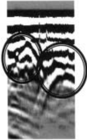
地中の埋設物 反射波波形が、放射線状の波形をなす。 下水管などの地下埋設物はこのような波形を示す場合が多い。この図においては大小2つの埋設管が確認できる
