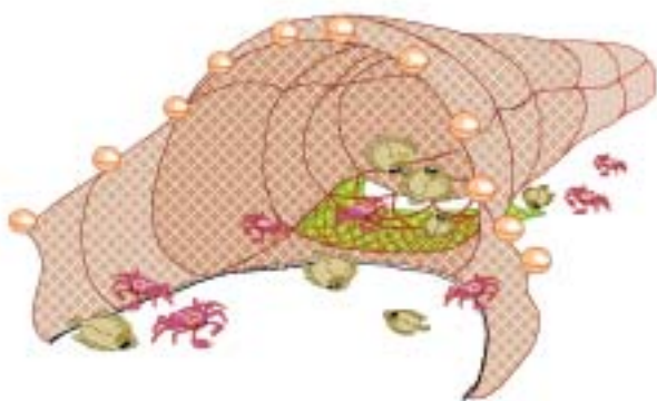
図7 操業中の選択網の水中模式図
