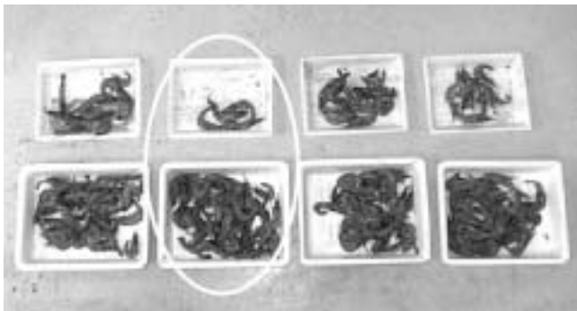
図10 サルエビの分離状態 上下2枚のパレットが1組の分離状態を表す。 上は選別機に残った個体、下は選別孔から落下した個体を示す。
