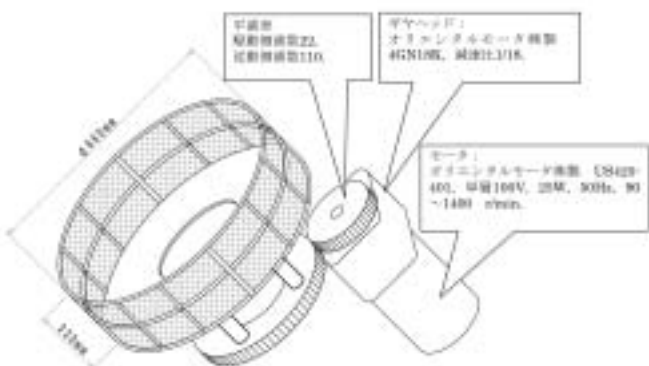
図2 円筒籠の駆動レイアウト
