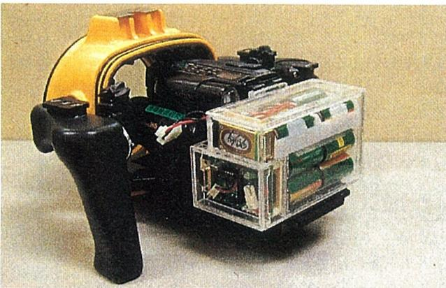
写真15 高容量バッテリーと間欠駆動装置
