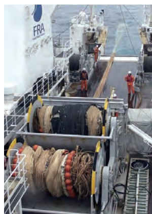
写真1 2段式トロールウインチ表層(手前)、中層(奥)の2網を巻き込んでいる
