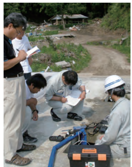
写真2 井戸能力パイロット調査
