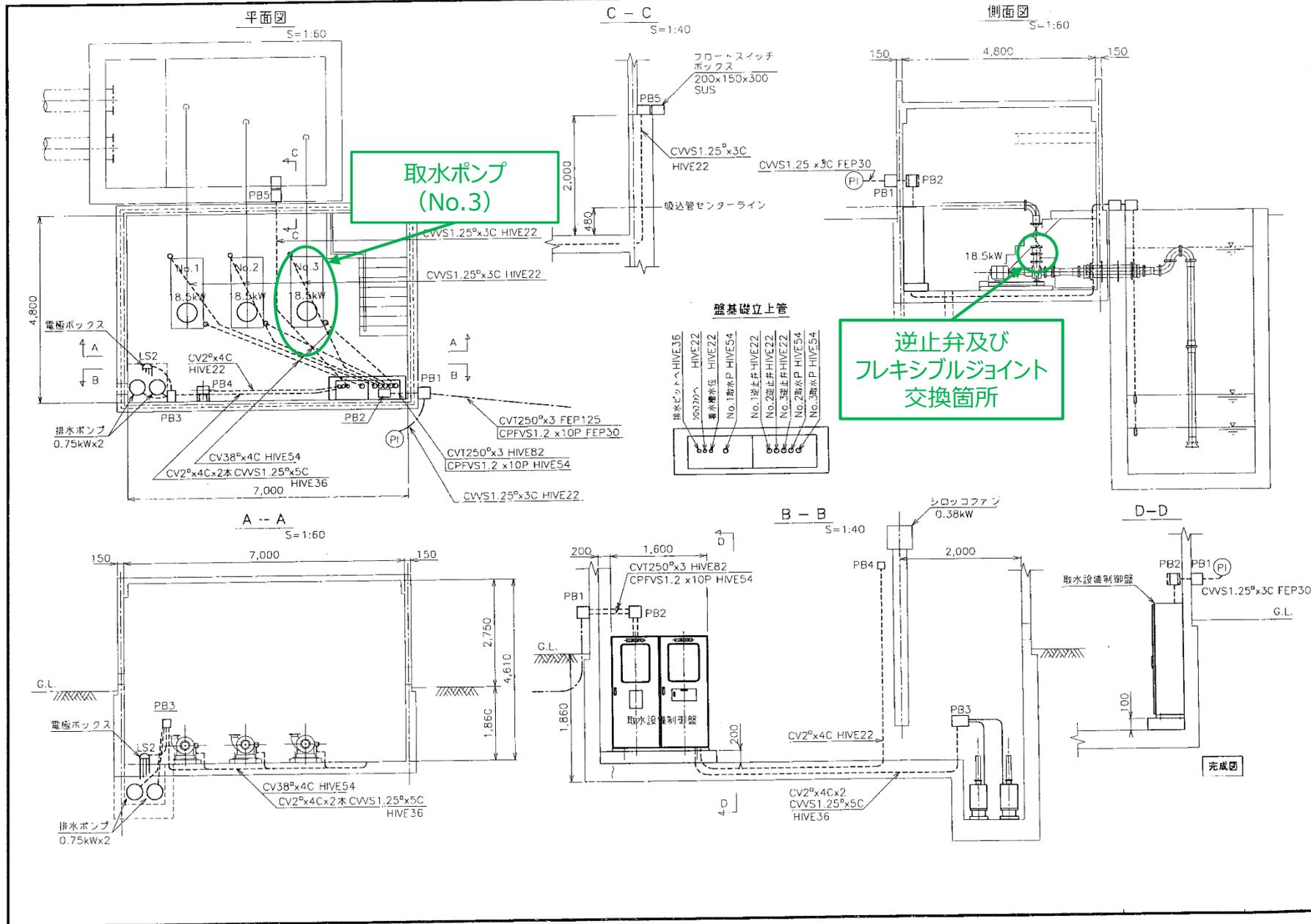
図2 送水ポンプ (No.3) 及び取替箇所
