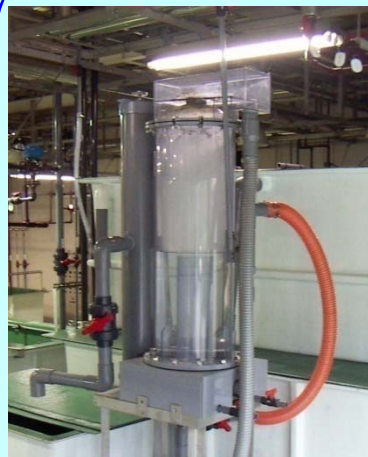
写真1 閉鎖循環飼育システムに設置された泡沫分離装置
