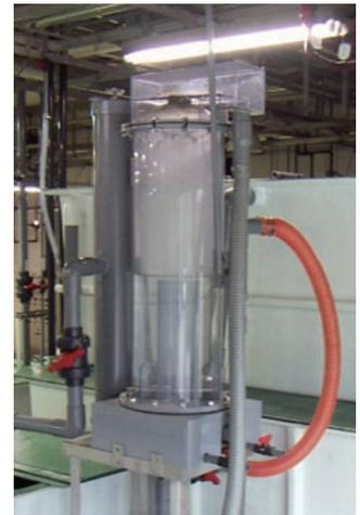
写真. 開発した泡沫分離装置。
