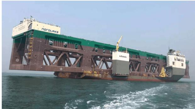
**Nordask "Havfarm 1"**：全長385メートル、最大10,000トン（200万尾）のサーモン飼育キャパシティを持つ。二号機の建造にも着手。
