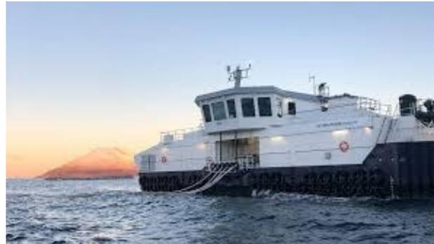
**AKVA社 AC850**：沖合養殖に不可欠なフィードバージ。電力と餌の供給拠点であり、オペレータに快適な居住性を提供する。
