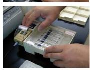
⑧ 蓋を閉じ、スイッチを負電荷の核酸が泳動されるようサンプル側の電極をマイナス(反対側がプラス)にセットし、100V(定電圧)で泳動を開始する。
