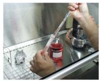
① 細胞が沈澱し、パックとなっている ことを確認し、上清の培養液を除去 する。
