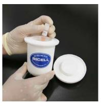
⑤ +4℃に予冷しておいたバイセル にバイアルをいれて、そのまま -80℃超低温冷凍庫へ保存する。バイセルのかわりにペーパータオル を使用する場合はバイアルに室温 のペーパータオルを巻いて、そのまま-80℃超低温冷凍庫へ保存する。
