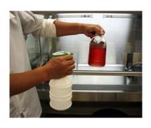
② 細胞培養フラスコ(器) および細胞分散の試薬瓶をアルコールスプレーしてクリーンベンチ内に搬入する。
