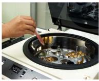
② 細胞浮遊液を遠心管に入れ、室温、 1200rpmで3分間遠心する。
