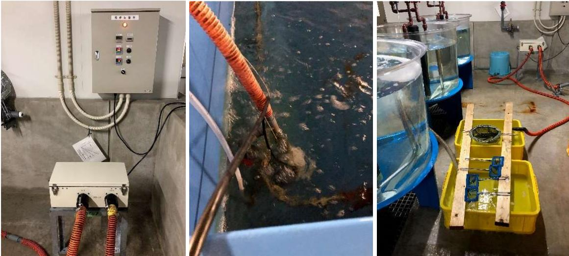
図 3.2-3 海水電解装置（左）、濁水ポンプ（中央）、および消毒槽（右）
