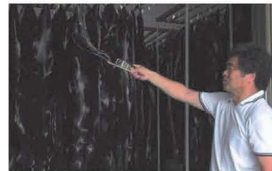
シャッター開口上部から外気の吸い込み → 乾燥が遅くなる
