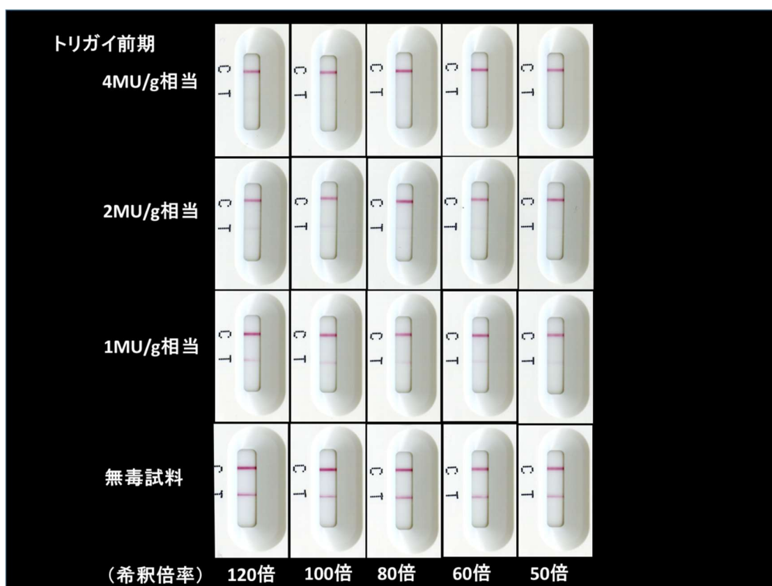
図 1. 無毒および各種の毒力に調製したトリガイの測定用抽出試料のキット分析（前期）
