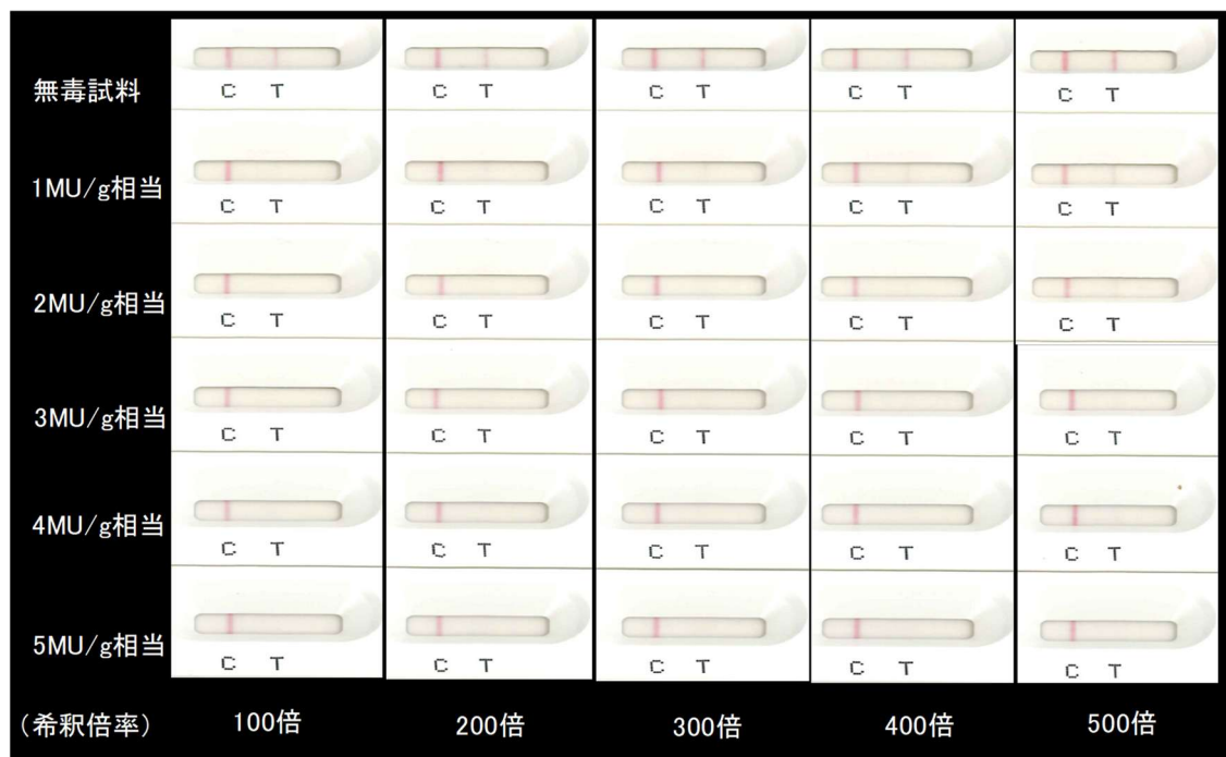
図1 無毒および各種の毒力に調製したヒオウギガイの測定用抽出試料のキット分析結果
