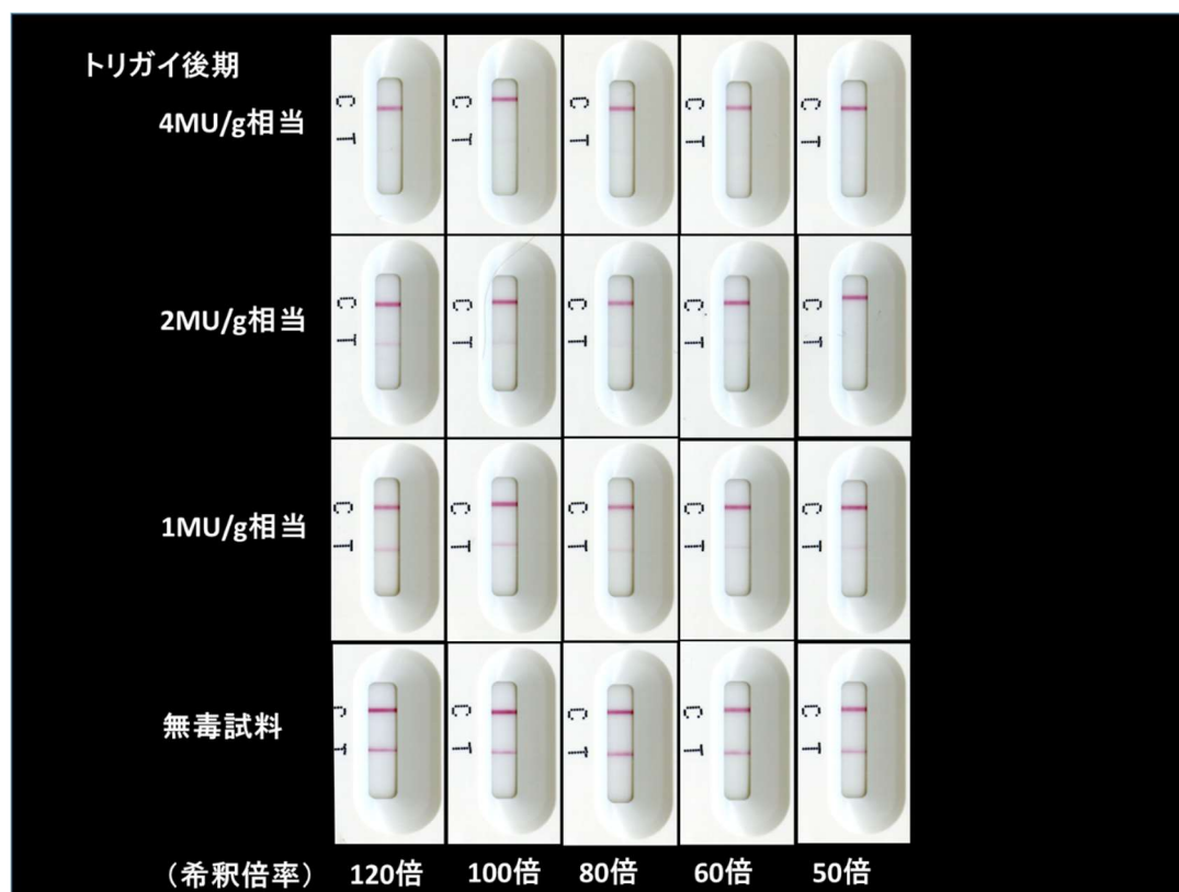
図2. 無毒および各種の毒力に調製したトリガイの測定用抽出試料のキット分析（後期）
