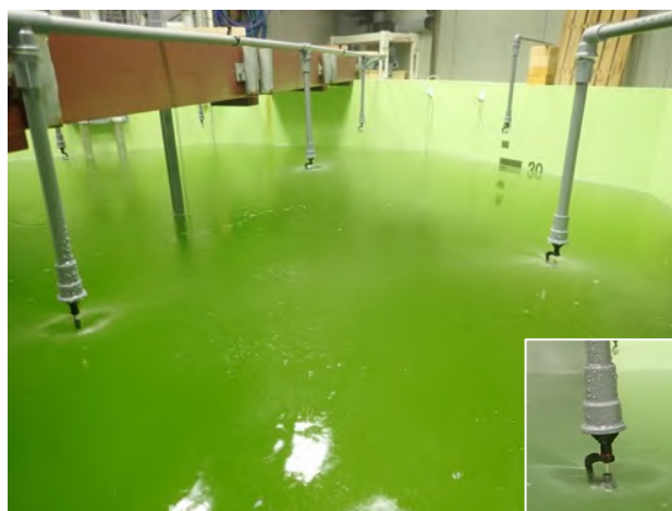
図2. 園芸用スプリンクラーを水面全面(1平方メートル当たり1個)に設置し海水を散布することでスジアラ仔魚の開鰓を促すことができる。
